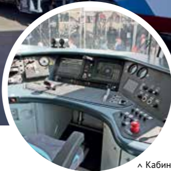
^ Кабина машиниста в «Иволге» оборудована системой климат-контроля, обогревом лобового стекла и небольшим холодильником
