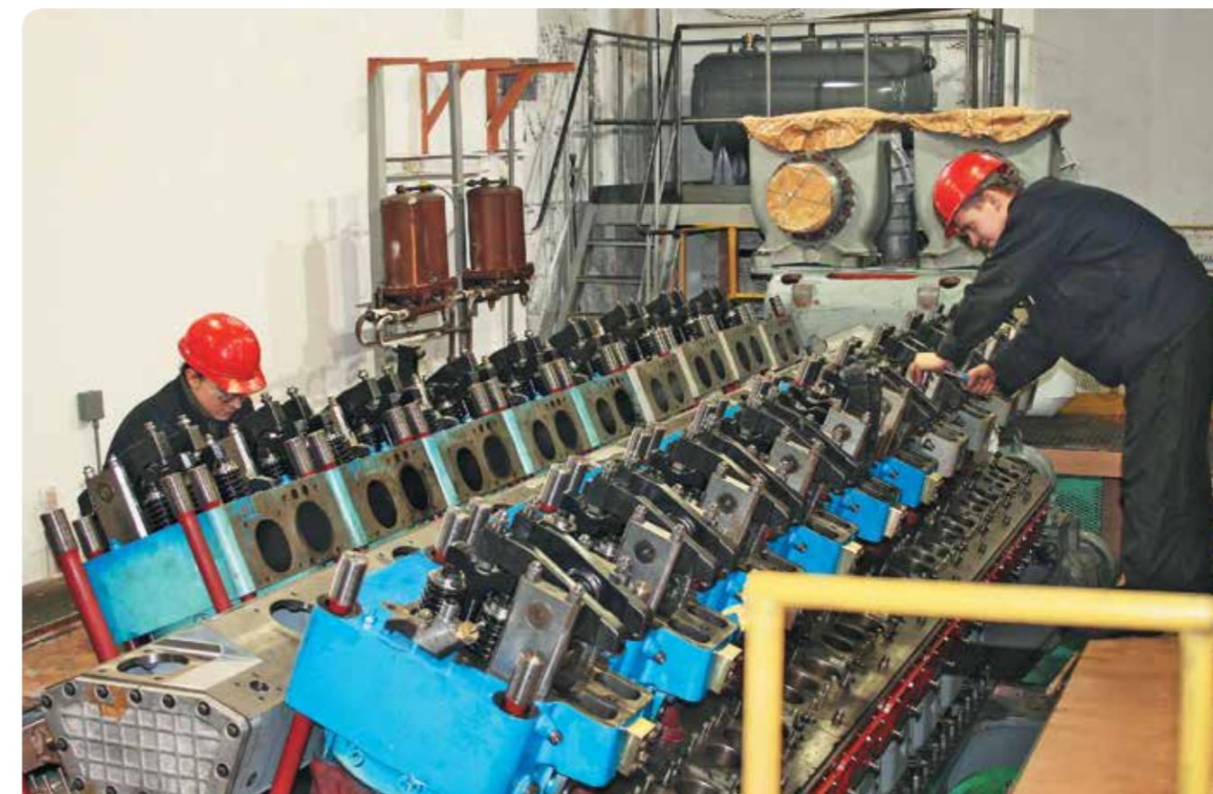
Сборка дизель-генератора 20ЭДГ500 для атомных станций
