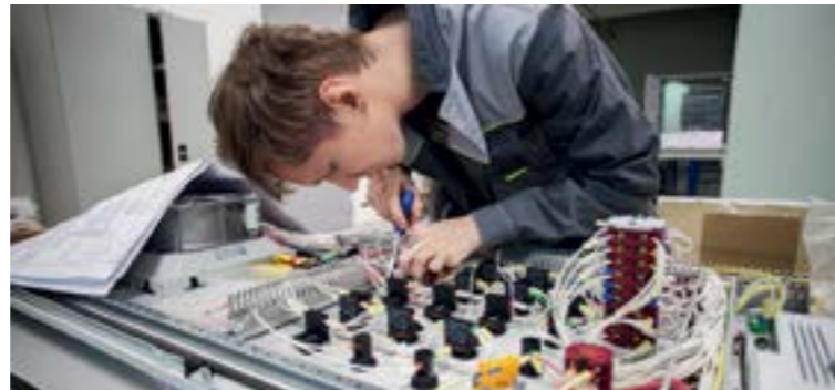
▲ Специалисты электроцеха «Эс-сервиса» создают электроприводы эскалаторов
