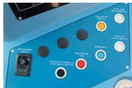
Панель управления вагонным оборудованием
